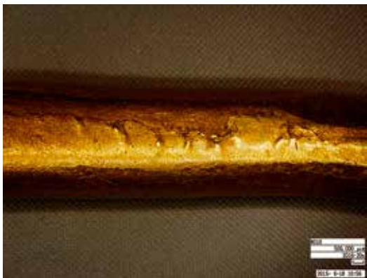
图2 金臂钏表面裂纹处的小褶皱（显微摄影： 首都博物馆文物保护分析实验室）
